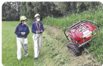
ラジコン草刈機による除草
